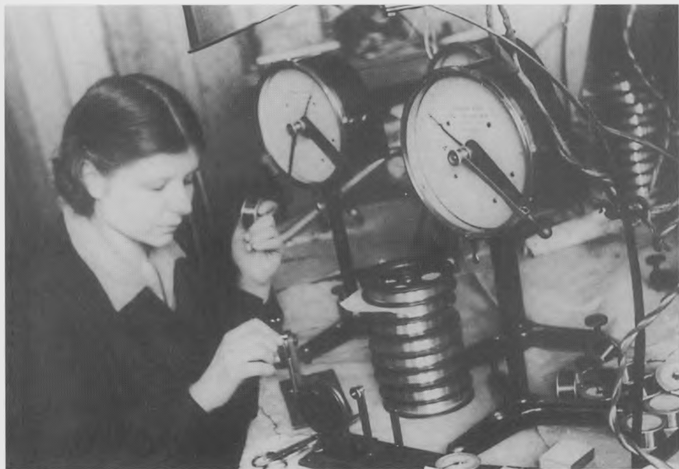
Вольфрамовый отдел. Работница контролирует качество нити
