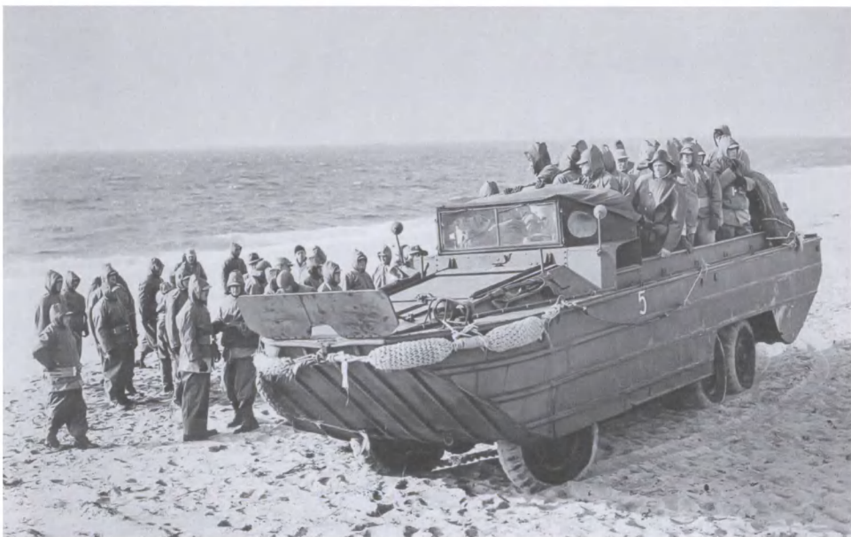
Автомобиль-амфибия GMC DUKW-353 «Утенок», выпущенный заводом «Дженерал моторс» и поставлявшийся по ленд-лизу в СССР в 1943–1944 гг.
