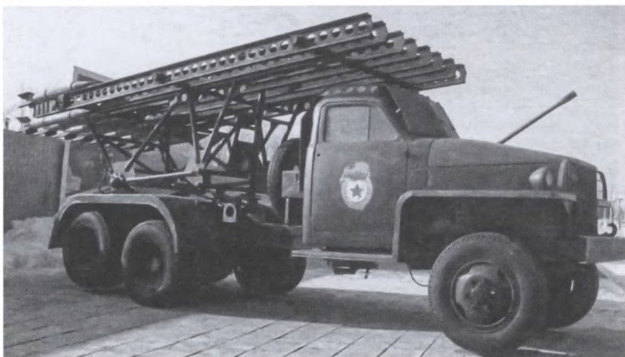
Установка БМ-13Н «Катюша» на шасси «Студебекера» US6 в экспозиции Музея военной техники в Верхней Пышме (Свердловская область)
