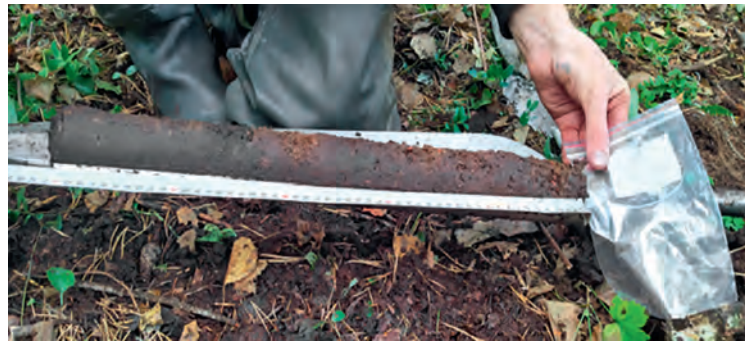
Рис. 7. Торфяной пробоотборник бура марки Eijkelkamp Peat Sample с отобранным сегментом керна. Фото Т. Г. Антипиной
